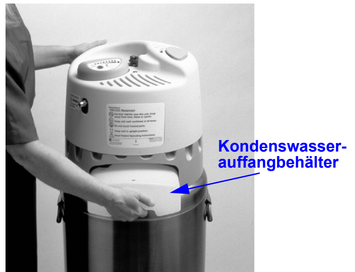
Abbildung 10: Auffangbehälter für Kondenswasser
