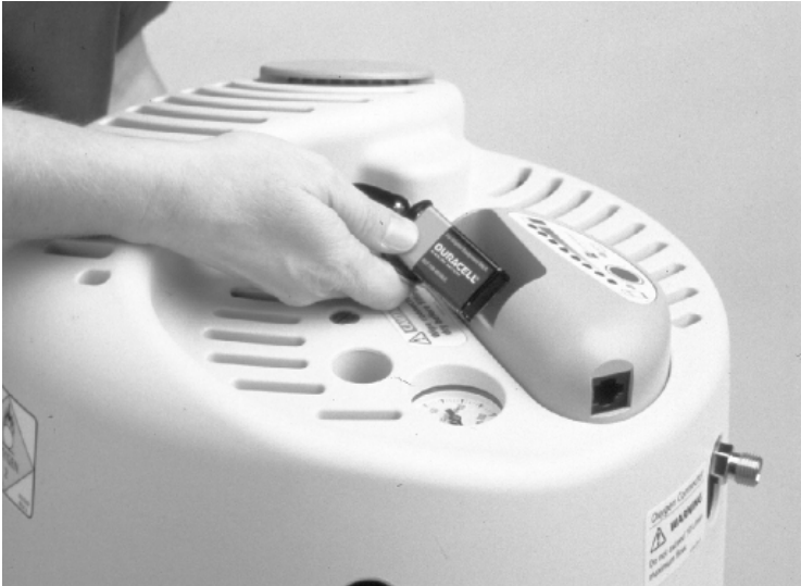
Figura 13. Sostituzione della batteria
