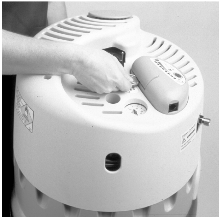
Figure 12: Compartiment de batterie
