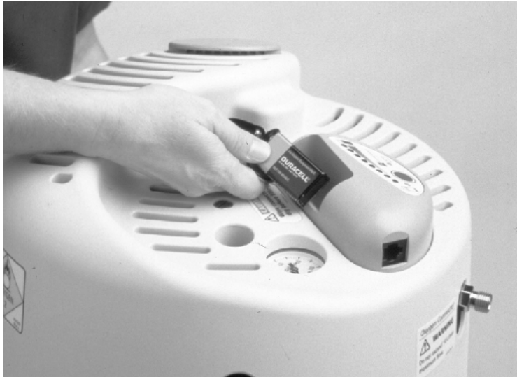
Figure 13: Remplacement de la batterie
