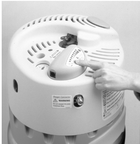
Abbildung 11: Überprüfen der Sauerstoffmenge im Vorratsbehälter
