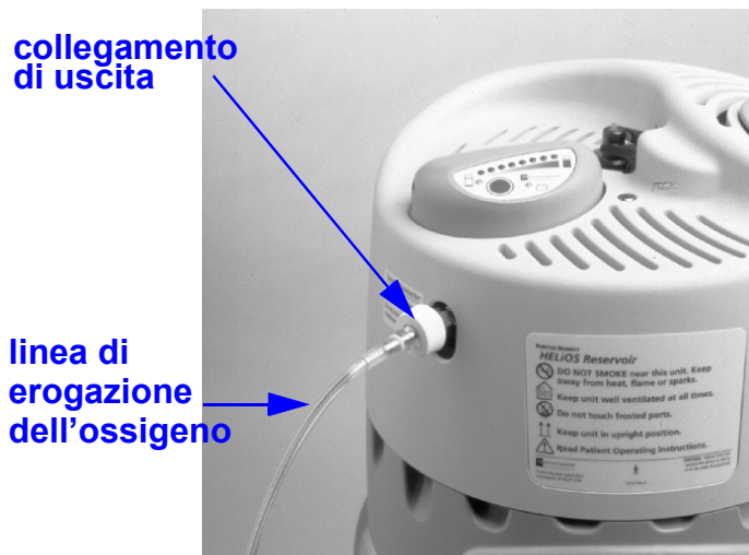
Figura 8. Collegamento della linea di erogazione al serbatoio
