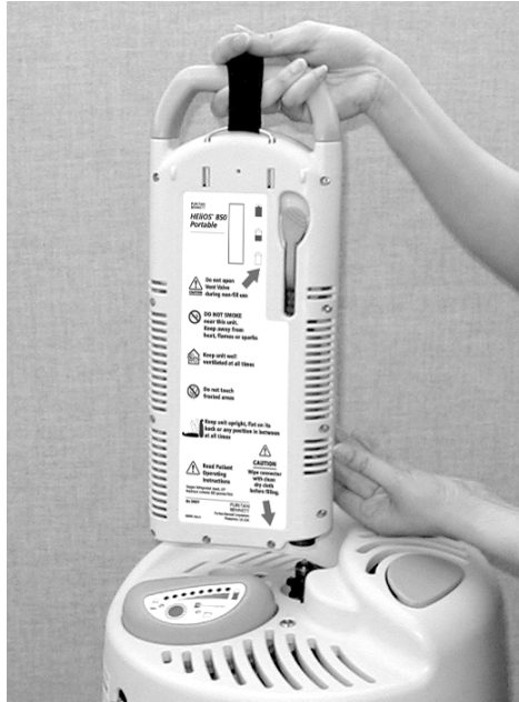
Afbeelding 1: De draagbare H850 in positie brengen voor het vullen
