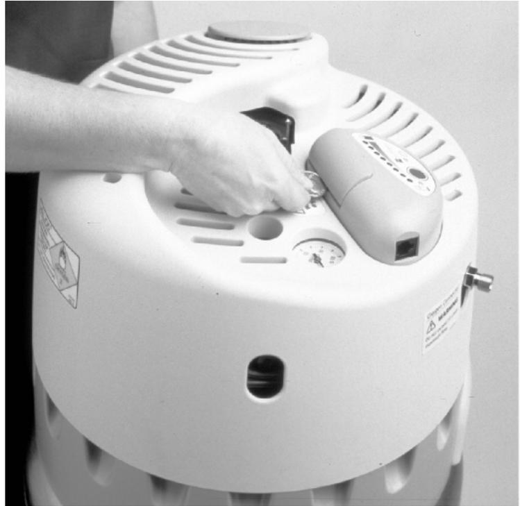
**Abbildung 12: Batteriefach**
