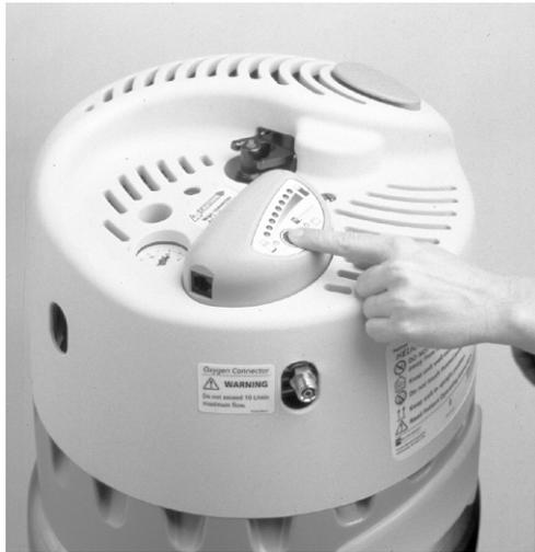
**Abbildung 11: Überprüfen der Sauerstoffmenge im Vorratsbehälter**
