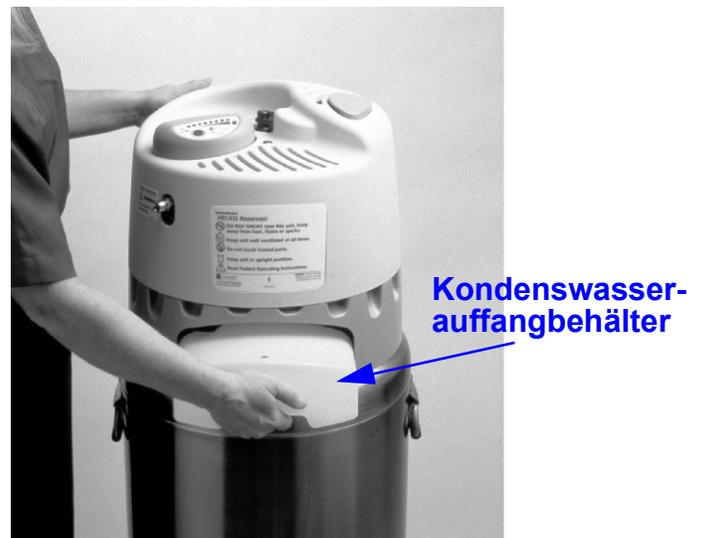
**Abbildung 10: Auffangbehälter für Kondenswasser**
