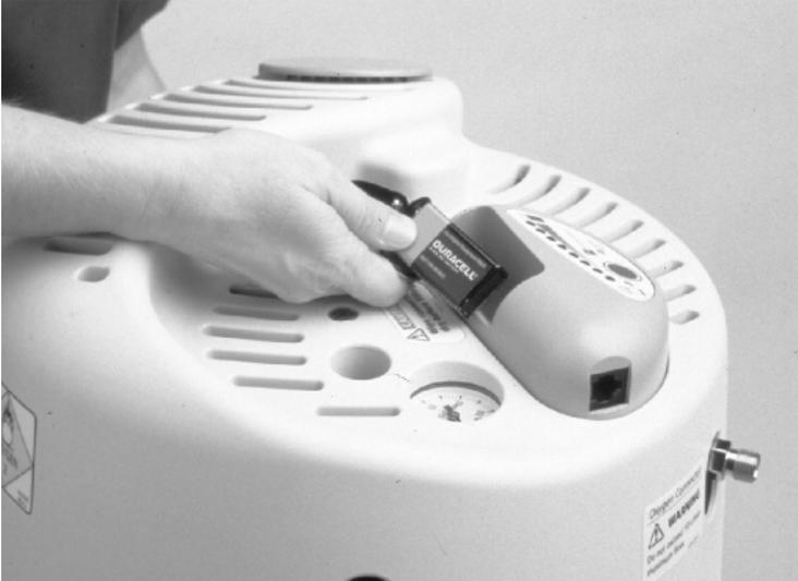
Abbildung 13: Auswechseln der Batterie
